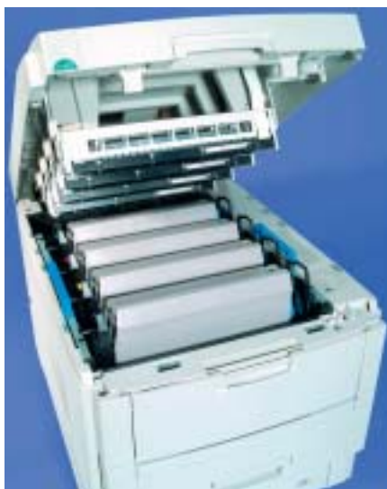
Bez laseru: Nahoře jsou vidět čtyři lišty s LED diodami, které mají u tiskárny OKI C7400 na starosti osvětlení obrazových válců, a to místo laserového paprsku.
