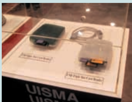
Čtečky paměťových karet s rozhraním USB, a to hned tři formátů najednou (na snímku vpravo): Smart Media, MemoryStick a Compact Flash. Mimochodem, na světě je USB 2 s čtyřicetnásobně vyšší přenosovou rychlostí (480 Mb/s) v porovnání se současným USB 1.1.
