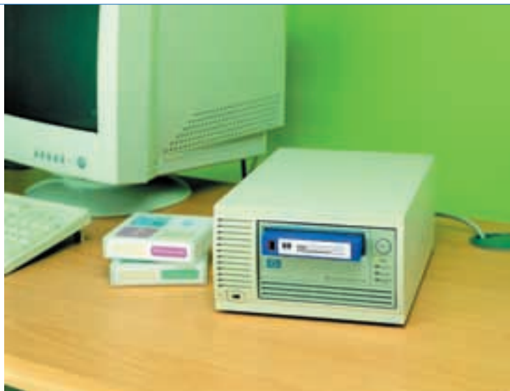
Nová mechanika firmy HP využívá technologii LTO.
