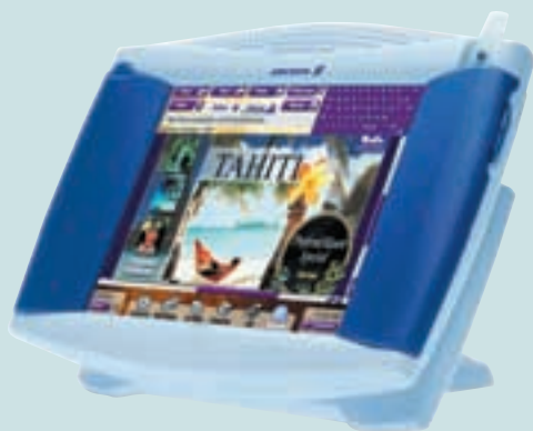
Domácí bezdrátový telefon Ericsson H600; kombinuje přístup k internetu, telefonii a elektronickou poštu, využívá technologii Bluetooth
