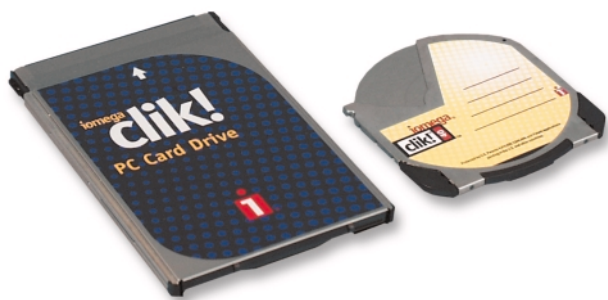
Hodinářská práce — mechanika Klik! PC Card Drive má velikost karty PC Card Type II.
