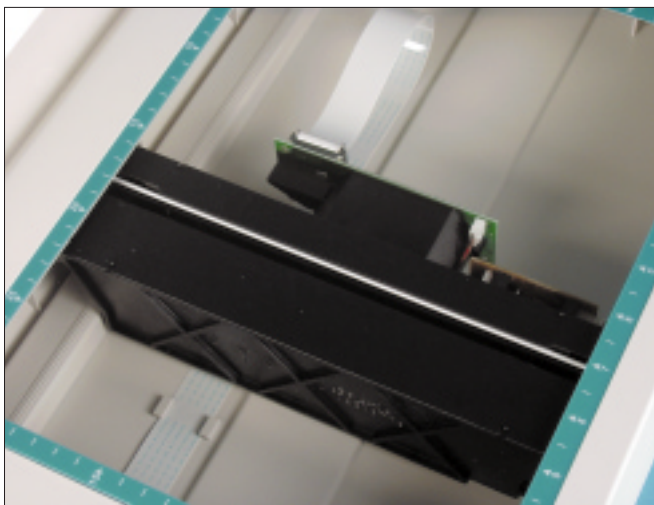
Snímací hlava s CCD prvkem je vyšší a mohutnější, poskytuje ale kvalitnější výstup.
