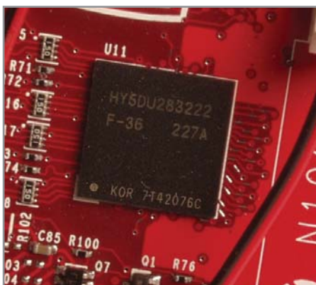
▲ Передовая оперативная память производства Hynix выпускается в корпусах FBGA, на верхних крышках которых четко указаны параметры
