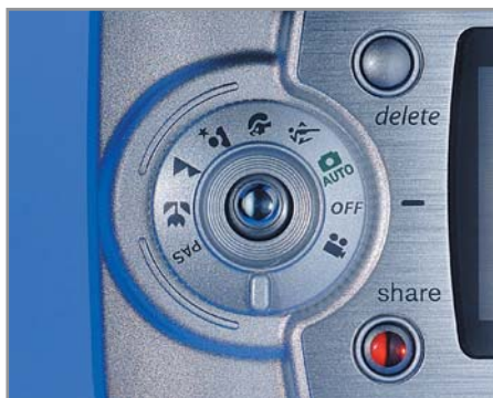
▲ При помощи установочного колеса на Kodak DX6340 можно выставить все важнейшие режимы съемки
