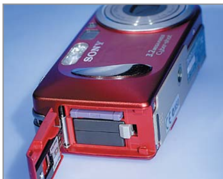
▲ Memory Stick и мощный литий-ионный аккумулятор располагаются под откидной крышкой Sony DSC-P8
