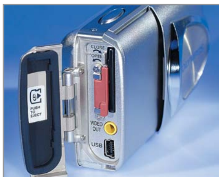
▲ Разъемы в камере Olympus защищены от попадания влаги крышкой с резиновым уплотнителем
