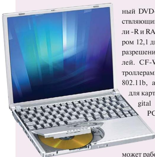
Внутри корпуса находится процессор Pentium M (Low Voltage, 900 МГц), 256 Мбайт оперативной памяти DDR SDRAM, винчестер объемом 40 Гбайт, а также двухформат-
