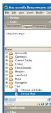
Рис. 7. Вкладка фрагментов кодов для многократного использования — Snippets
