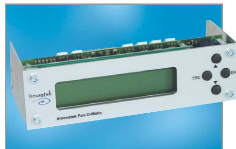
▲ Компьютер в компьютере: устройство Fan-O-Matic (около €170) представляет собой мини-компьютер, позволяющий контролировать работу до пяти вентиляторов и управлять ими
