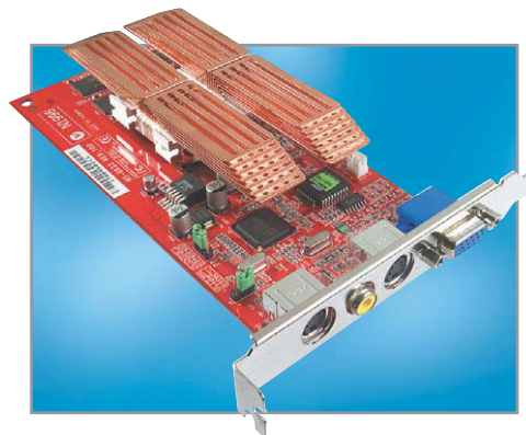
▲ «Медь охлаждающая»: именно такой радиатор нужен видеокарте в тесном пространстве системного блока
