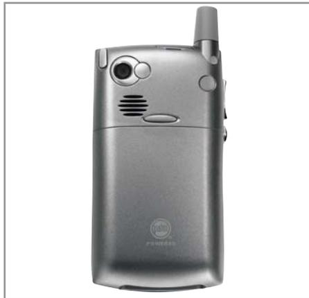
▲ VGA-камера и динамик у Treo 650 расположены на задней крышке
