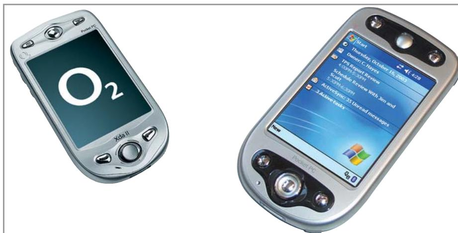
▲ Коммуникаторы Xda II и MDA II, созданные одним и тем же производителем, различаются только предустановленным ПО
