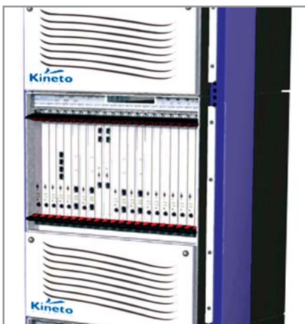
▲ Контроллер UNC служит мостом между UMA и сотовой сетью
