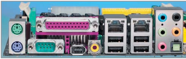
◀ Свободных мест нет (слева направо): PS/2, IEEE-1284, RS-232, FireWire, видеовыход, два Gigabit Ethernet, USB 2.0 и восьмиканальный звук
