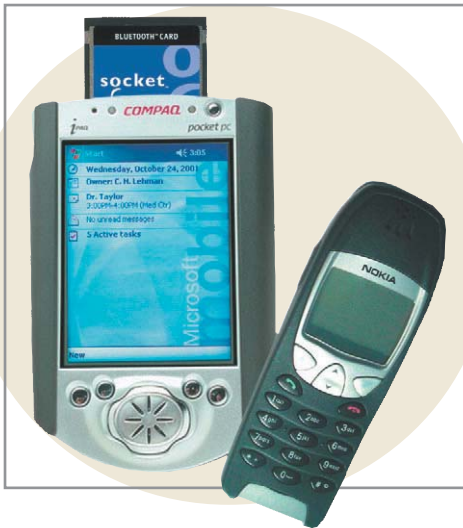
Телефон и КПК от разных производителей прекрасно понимают друг друга при помощи протокола Bluetooth
