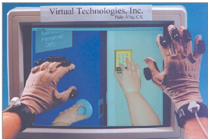
Рис. 4. Перчатки CyberGlove и устройство CyberTouch обеспечивают взаимодействие с VR-миром
