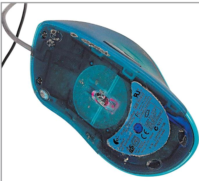
**5** Сенсор оптической мыши тоже подвержен загрязнению и может быть поцарапан. Поэтому периодически следует очищать зону оптического сенсора, а зеркальце-рефлектор — полировать
