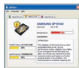
Контролировать состояние винчестера лучше всего при помощи программы HDDlife Pro. Эта утилита может не только отображать данные об устройстве, но и предсказывать его выход из строя. ■
