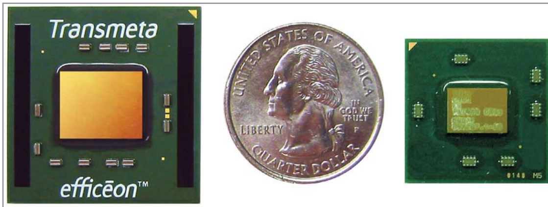
◀ Crusoē TM5900 (справа) и новый Efficēon TM8600 (слева) по габаритам сравнимы с 25-центовой монетой. Более поздняя модель чуть крупнее
