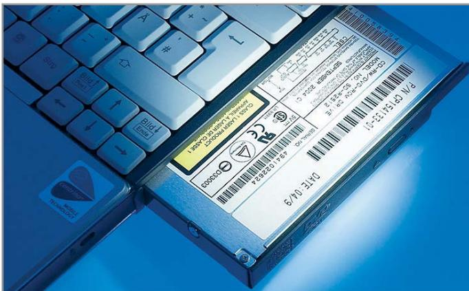
▲ Модульная структура Fujitsu-Siemens допускает использование разных типов жестких дисков
