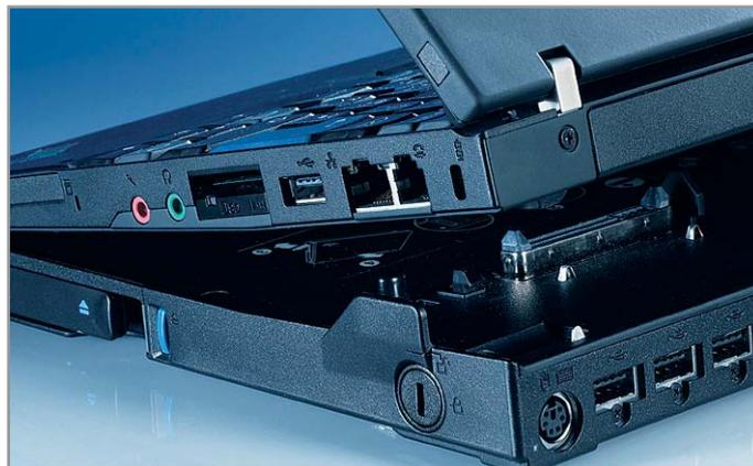
▲ Док-станция IBM добавляет ноутбуку несколько портов и такое важное устройство как оптический привод
