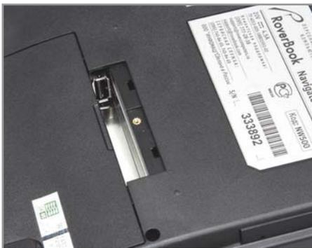
▲ Модель RoverBook W500WN оснащена дополнительным USB-портом, спрятанным под крышкой
