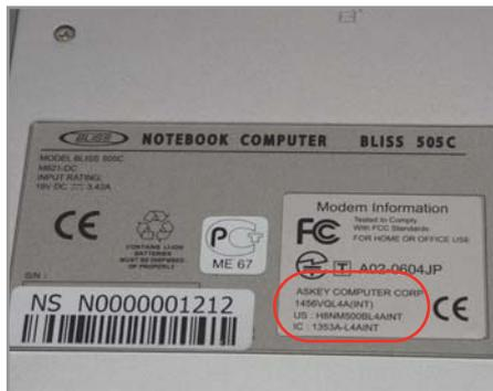
▲ Некоторые производители приводят данные о разработчике шасси для конкретного ноутбука
