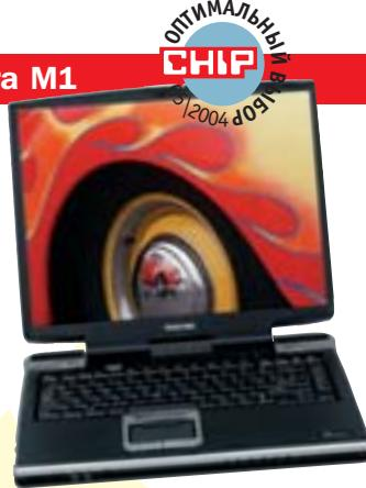
Аккумулятор данной модели заслужил максимальную оценку: ноутбук Tecra M1 проработал с офисными приложениями 9 часов и 26 минут. Ни один серийный аккумулятор емкостью 71 Вч не работал в нашей лаборатории дольше. Это стало возможным благодаря применению технологии Intel Centrino и оптимальному подбору комплектующих.
