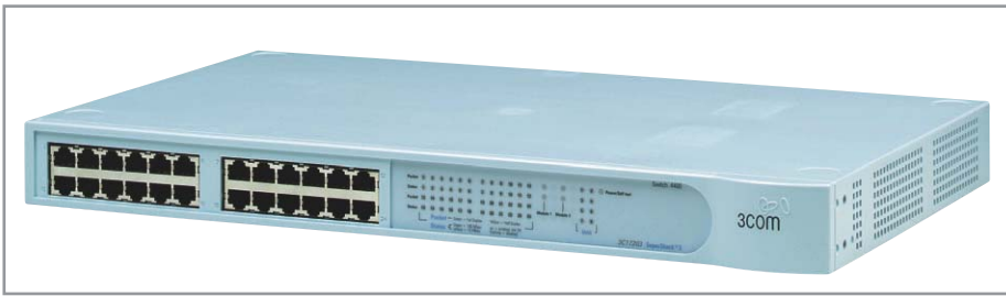
▲ Для крупных сегментов сетей используются многопортовые концентраторы. В небольших сетях такое оборудование не встречается
