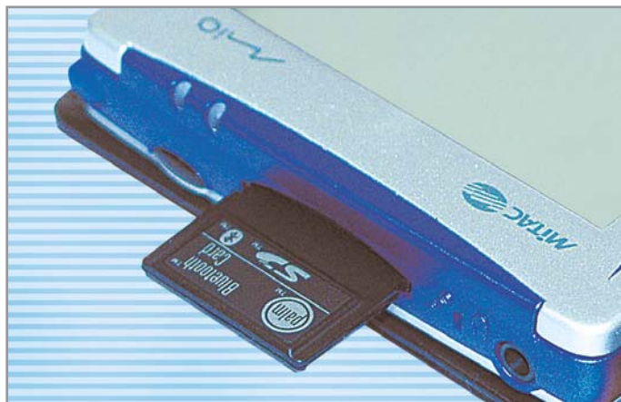
▲ К сожалению, подобная связка неработоспособна, так как в ОС PocketPC поддержка устройства не предусмотрена
