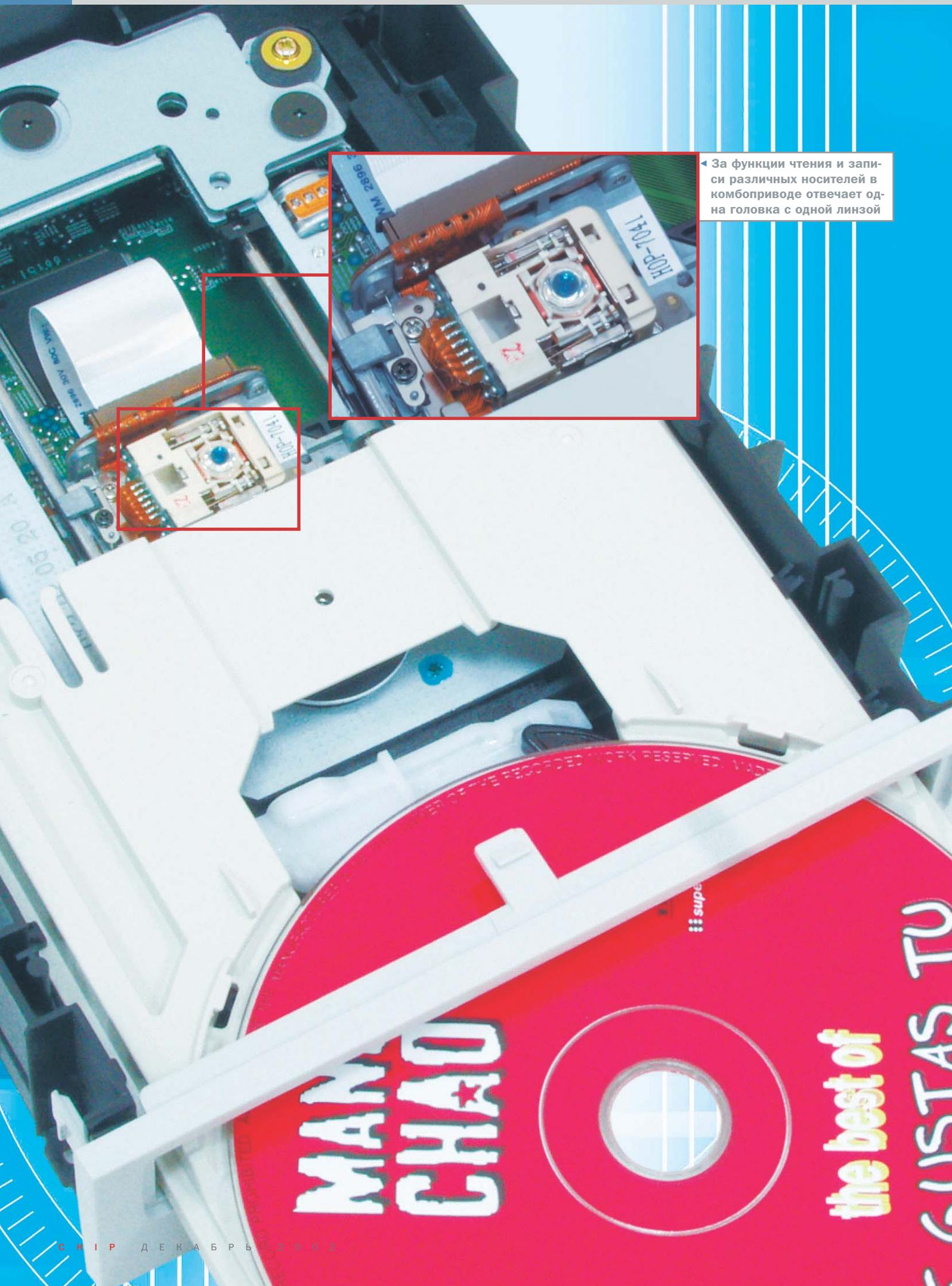
◀ За функции чтения и записи различных носителей в комбоприводе отвечает одна головка с одной линзой
