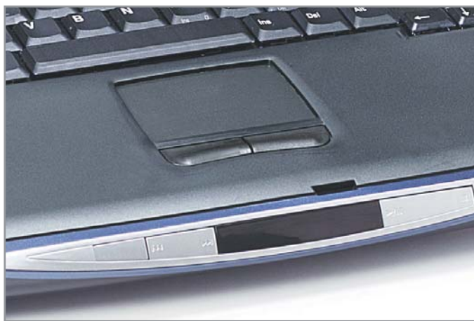
◀ Комфорт во всем: Toshiba Satellite 1900-102 имеет на передней панели кнопки управления CD-плеером
