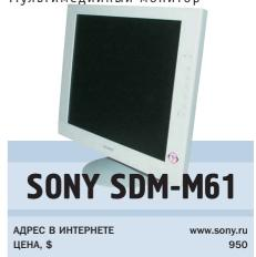
Максимальное разрешение, в котором способен работать этот монитор, 1280х1024 пикселя, соответствует физическому разрешению ТГТ-панели. При работе в этом разрешении монитор показывает себя очень хорошо. Геометрия изображения идеальна, правда, как и у всех ЖК-мониторов. Цветопередача тоже достаточно хорошая но, как и у SDM-M81, до ЭЛТ-мониторов она не дотягивает. Оттенки градиента от 80 до 100% черного практически неразличимы.
