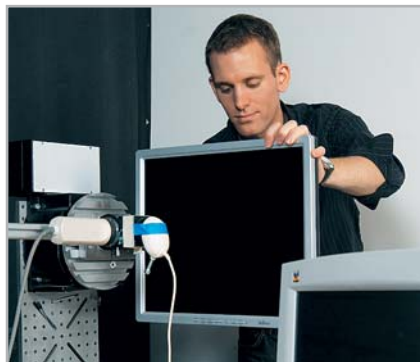
Eingepasst: CHIP-Volontär Dominik Grau montiert den Testkandidaten am TFT-Schwenktisch.
