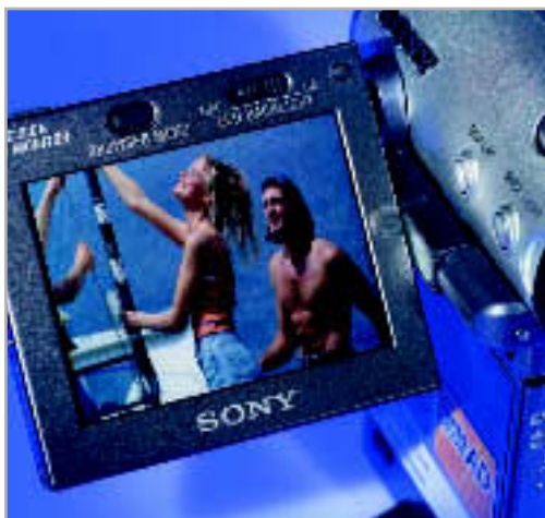
GENIAL: Das transflektive Display der kleinen Sony funktioniert auch ohne Hintergrund-Beleuchtung.
