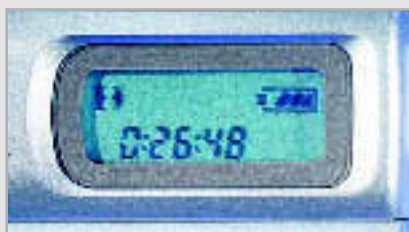
ZUVERLÄSSIG: Akkumessung und Bandzählwerk arbeiten bei Sony sehr genau.
