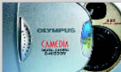
KLAPPE DICHT: Der Verschluss schützt die Linse und dient auch als Ein-/Aussschalter.
