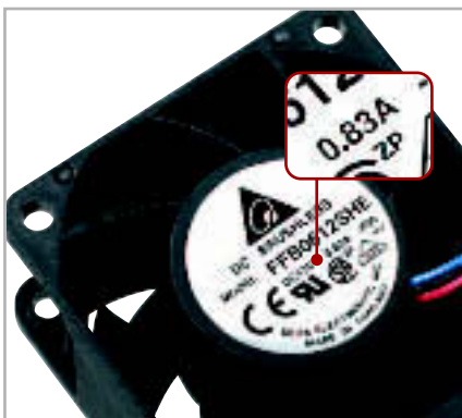
1 GIERIG: Mancher Lüfter saugt mehr Strom, als das Mainboard verträgt. Ist er zu gierig, geht das Board in die Knie.
