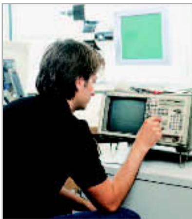
JETZT ABER SCHNELL: Testingenieur Torsten Neumann misst mit Fotodiode und Oszilloskop die Bildaufbauzeiten der TFT-Flachbildschirme.
