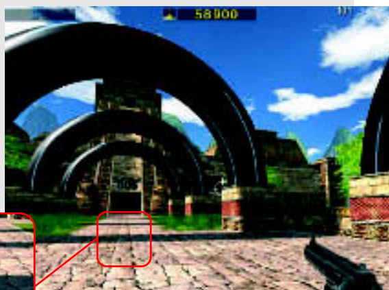
FILTER-VERGLEICH: Während der herkömmlich gefilterte Ausschnitt (links) in der Ferne versumpft, bleiben die Texturen mit der anisotropen Filterung (rechts) scharf.
