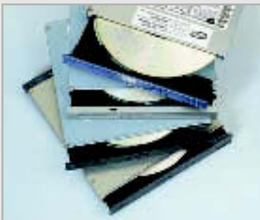
BLENDEN-CHAOS: Jeder Hersteller optischer Notebook-Laufwerke verwendet für die Frontblende eigene Standards.
