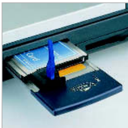
DRAHTLOS GLÜCKLICH: Dieses ältere Notebook ist dank PCMCIA-Aufrüstung jetzt W-LAN- und Bluetooth-tauglich.
