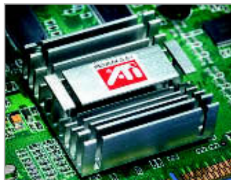
LAUTLOS & PFLEGELEICHT: Passiv-Kühler bewahren vor Extra-Lärm und halten ewig – für kühlere 3D-Chips die Lösung der Wahl.
