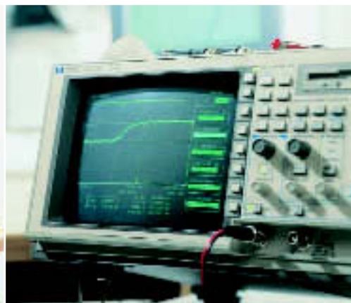
TFT-DISPLAYS IM TEST: Testingenieur Torsten Neumann prüft die 17- und 18-Zoll-Displays auf Herz und Nieren. Die Anstiegs- und Abfallzeit ergeben zusammen die so genannte Reaktionszeit. Eine niedrige Reaktionszeit ist gut für Video und Spiele.
