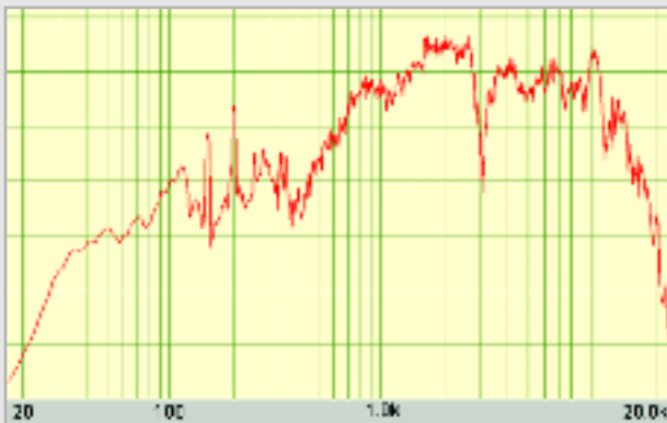
KLANGBILD: Zerklüftet und extrem ungleichmäßig – dieser Frequenzgang ist typisch für die getesteten Camcorder.
