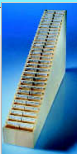
CHIP-MAKROTREPPE: Mit dieser Messvorrichtung ermitteln wir die Makrotauglichkeit.
