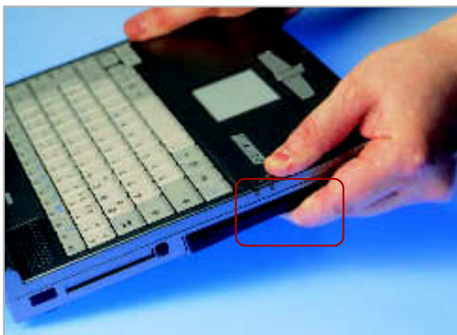
FLEXIBILITÄT MAL ANDERS: Labiles Gehäuse und Slot-in-Laufwerk beim Gericom Webshox. Hoffentlich überleben Medium und Laufwerksmechanik.
