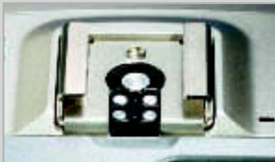
ZWEITBLITZ: Über spezielle Kontakte steuert die Canon die Blitzintensität.
