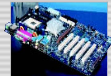
FÜR ENTHUSIASTEN: Das P4-Board D845PEBT2 mit i845PE-Chipsatz, DDR333-Support und RAID (0 und 1) per SerialATA.
