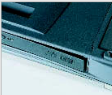
SCHÖNHEITSFEHLER: Passt die Blende wie hier nicht ganz, so lässt sich mit Feile und Modellbaufarbe nachhelfen.
