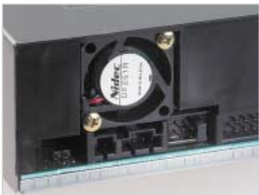
LUFTIKUS: Auch der neueste Plextor-Brenner will auf seinen Lüfter nicht verzichten – also wieder eine Schallquelle mehr im PC-Gehäuse.
