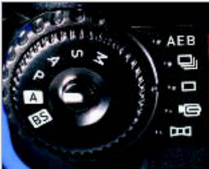
FEHLERQUELLE: Verstellt man das obere Rad der Casio, kann sich der untere Einstellring ungewollt mitdrehen.
