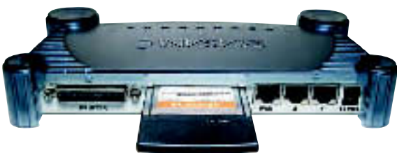
SCHICK, ABER EMPFINDLICH: Die PC-Karte des Asanté sitzt zu locker und bricht schnell ab.
