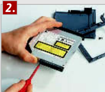
2. ANPROBE: Vor dem Einbau wird das neue Laufwerk mit den alten Adapter- und Gehäuseteilen ausstaffiert.
