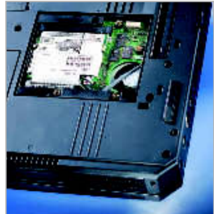
KOMMUNIKATIV: IBMs Thinkpad T30 mit Mini-PCI-W-LAN und Bluetooth-Option.
