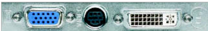
PRAKTISCH STANDARD: Die heute gängige Slotblech-Bestückung mit VGA-Anschluss, Kombi-Buchse für TV-In und -Out sowie DVI-I-Port für Analog- und Digital-Signale.
