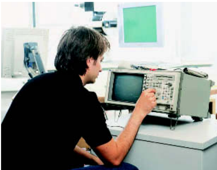
TFT-DISPLAYS IM TEST: Testingenieur Torsten Neumann prüft die 17- und 18-Zoll-Displays auf Herz und Nieren. Die Anstiegs- und Abfallzeit ergeben zusammen die so genannte Reaktionszeit. Eine niedrige Reaktionszeit ist gut für Video und Spiele.
