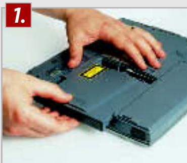
1. ALTES CD-LAUFWERK AUSBAUEN: Optische Laufwerke lassen sich meist einfach als Modul herausziehen.
