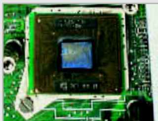
MOBILER PENTIUM-III: Diese CPU (P-III/900) im Micro-PGA-2-Format lässt sich auswechseln.
