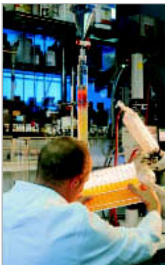
CHEMIELABOR STATT CHIPFABRIK: Die Chromatographensäule (Hintergrund) reinigt den produzierten Farbstoff. In den Gläsern des Fraktionensamplers findet der Chemiker die gesuchte Verbindung und sortiert Nebenprodukte aus.
