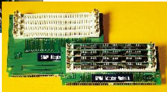
Die gängigsten Shuttles: Oben die spiegelverkehrte Version und rechts die Kurz-Langen. Welches Shuttle Sie benötigen, hängt vom Platzangebot im Inneren des PC ab.
