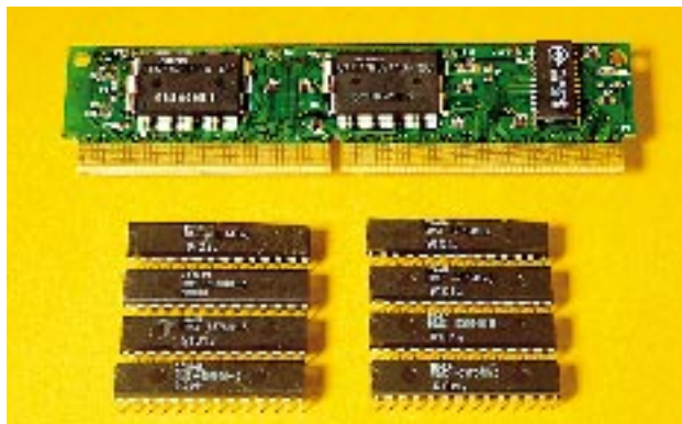
Cache: In modernen PC findet man kaum mehr DIL-Schaltkreise (unten), sondern nur noch Coast-Cache (oben)
