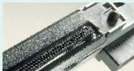
Mehrere LED-Zeilen sorgen beim Okipage 4W für die Belichtung der Entwicklereinheit
