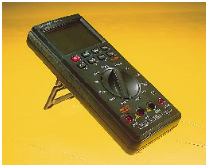
Dokumentiertes Messen: Die serielle Schnittstelle reicht die Meßdaten an den PC weiter, wo man sie auswertet
