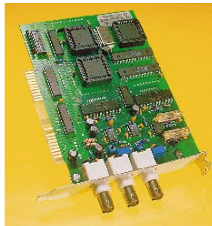
Kurvenreich: Die Oszilloskopkarte macht den PC zu einem interessanten Meßgerät, allerdings mit Software-Schwächen
