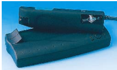
Schafft nur Zeilen: Die maximale Scanbreite des Irispen beträgt einen Zentimeter
