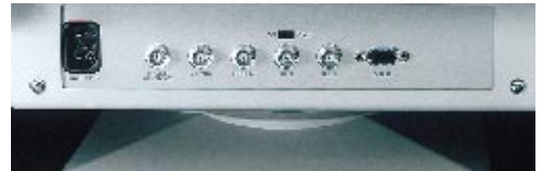
Kontaktfreudig: An BNC- und D-Sub-Buchsen arbeiten auch zwei Rechner
