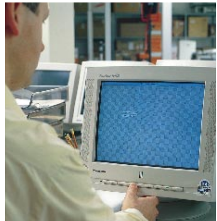
Fehlersuche: Das schachbrettartige Testbild entlarvt unscharfe Monitore
