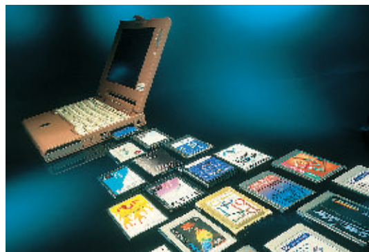
Kartenspiel: Über einen PCMCIA-Steckplatz kann das Funktionsspektrum eines Notebooks fast beliebig erweitert werden
