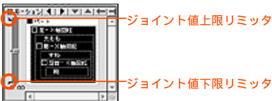
図6 ジョイント値上限リミッタとジョイント値下限リミッタ
