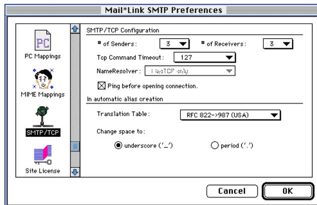
Figure 23 SMTP/TCP network parameters
