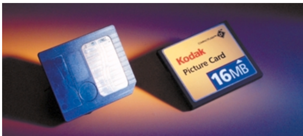
V digitálních fotoaparátech se používají paměti SmartMedia nebo CompactFlash.
