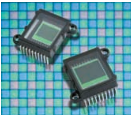
Místo filmu se u digitálních fotoaparátů používá CCD prvek.
