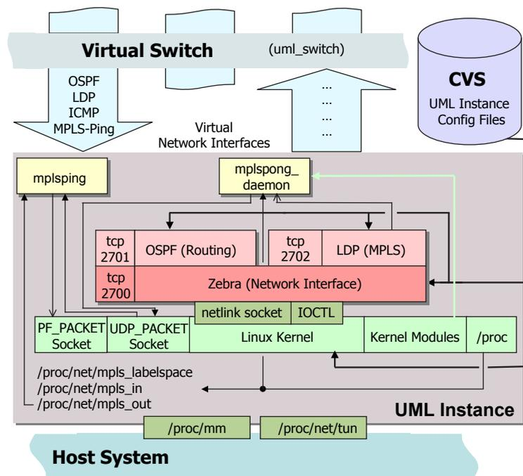
Abbildung 3: Verbindungen einer UML-Instanz mit dem virtuellen Switch des Testnetzes
