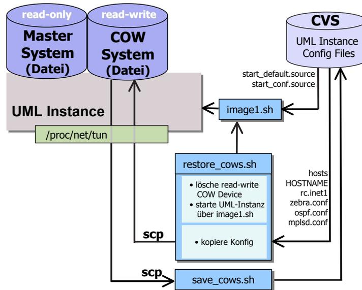
Abbildung 2: Verarbeitung von Konfigurationsdaten einer UML-Instanz mit *image1.sh*, *restore\_cows.sh* und *save\_cows.sh*
