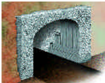
Figura 3: Se puede aumentar la capacidad para soportar carga de una tubería, al aplicar refuerzo con fibras en la superficie interna o externa.
