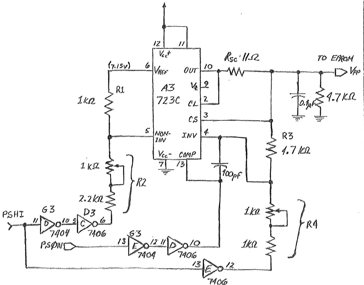
TYPICAL ADJUSTMENT RANGES OF OUTPUT : PSHI = 0 :  $(9.5 \leq V_{pp} \leq 5.1)$
