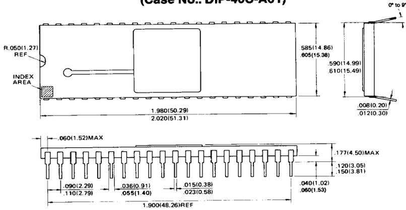
**40-LEAD PLASTIC DUAL IN-LINE PACKAGE**
